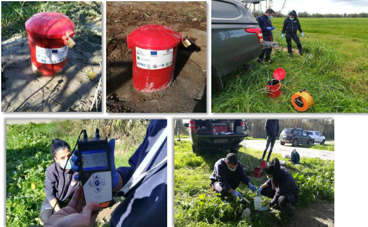
Photos 1-5 - Piezometers n.1, 2 and the water sampling
