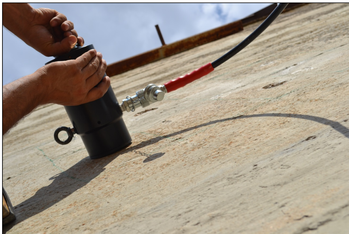
Figura 47 - Prove Pull Out. Fase di Posizionamento dello Strumento
