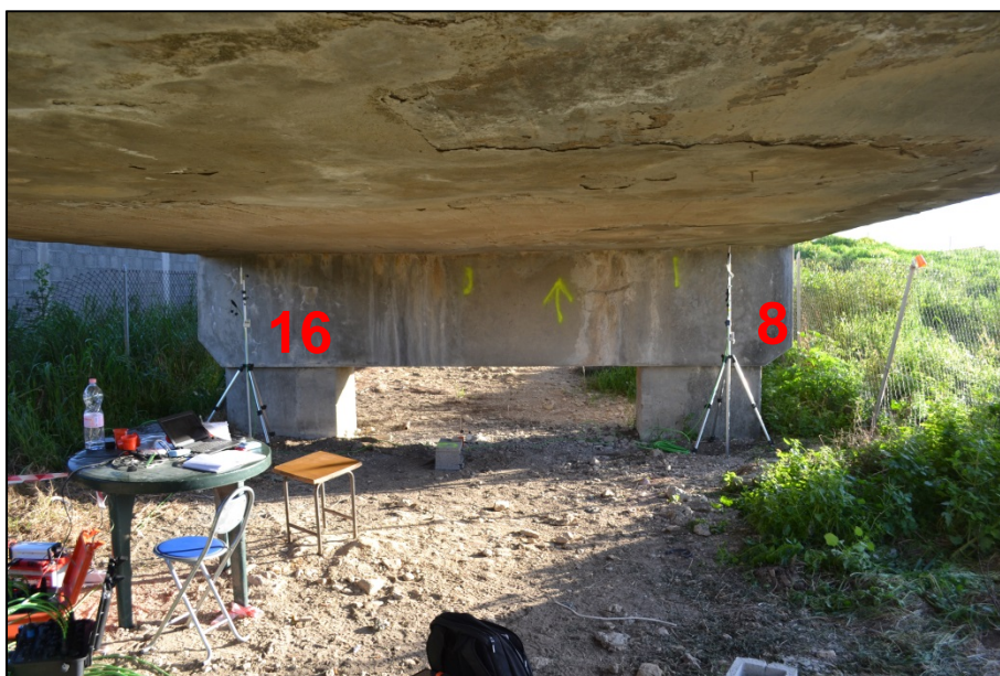
Figura 35 - Immagine del Posizionamento dei Trasduttori all'Intradosso di parte della Campata tra le Travi 14°-15° del Ponte Canale Guasila I, Prova del 15.04.2013
