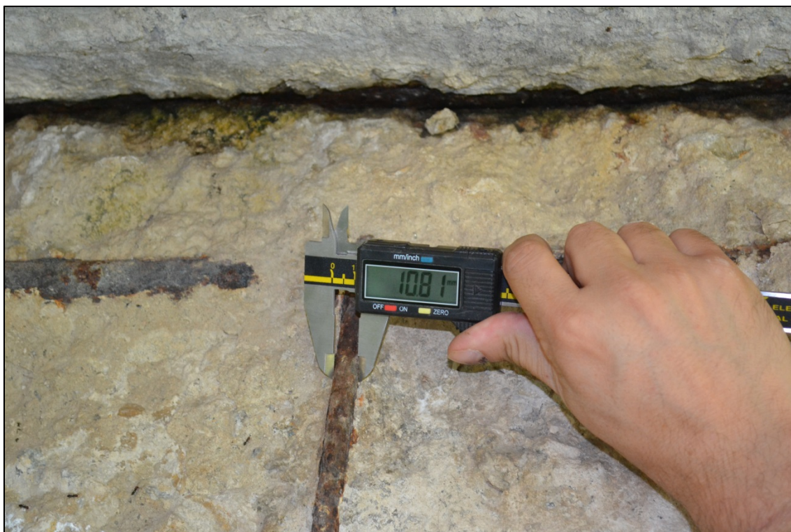
Figura 22 - Ponte Canale Guasila I - Rilievo Diretto del Diametro delle Armature - Trave - Armature Verticali
