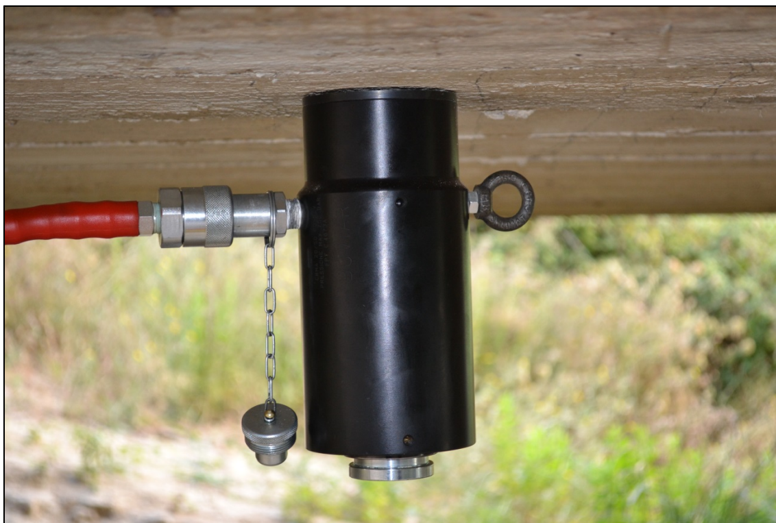
Figura 48 - Prove Pull Out. Posizionamento Martinetto e Stelo di Estrazione
