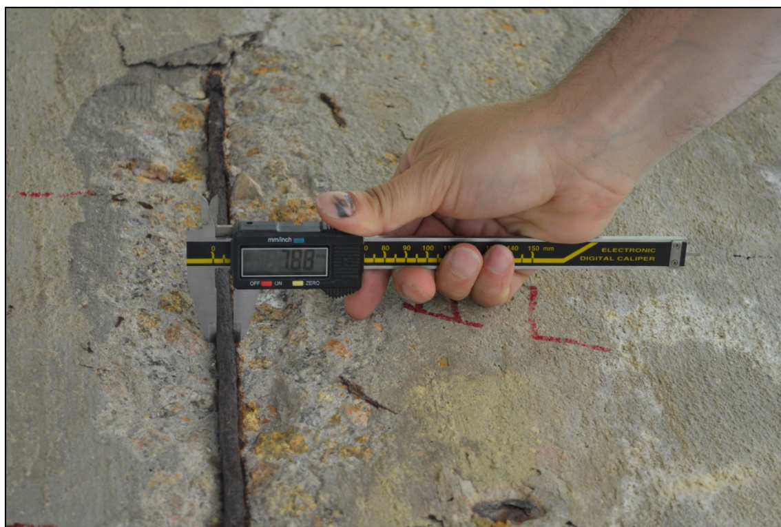
Figura 17 - Ponte Canale Guasila I - Rilievo Diretto del Diametro delle Armature - Solaio - Armatura Longitudinale
