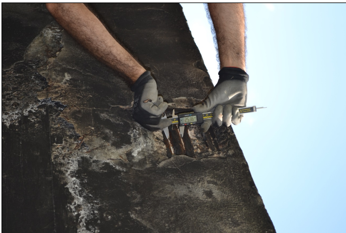
Figura 24 - Ponte Canale Guasila I - Campata Speculare - Misura del Diametro con Calibro Digitale
