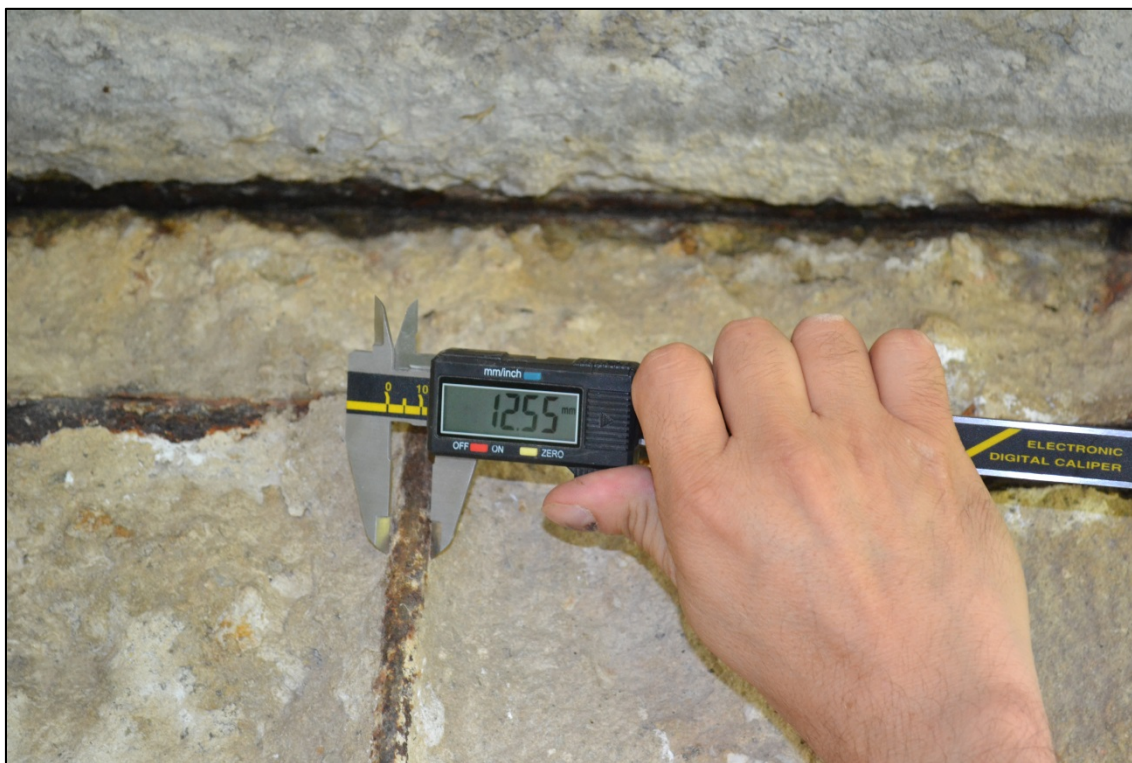
Figura 21 - Ponte Canale Guasila I - Rilievo Diretto del Diametro delle Armature - Trave - Armature Verticali
