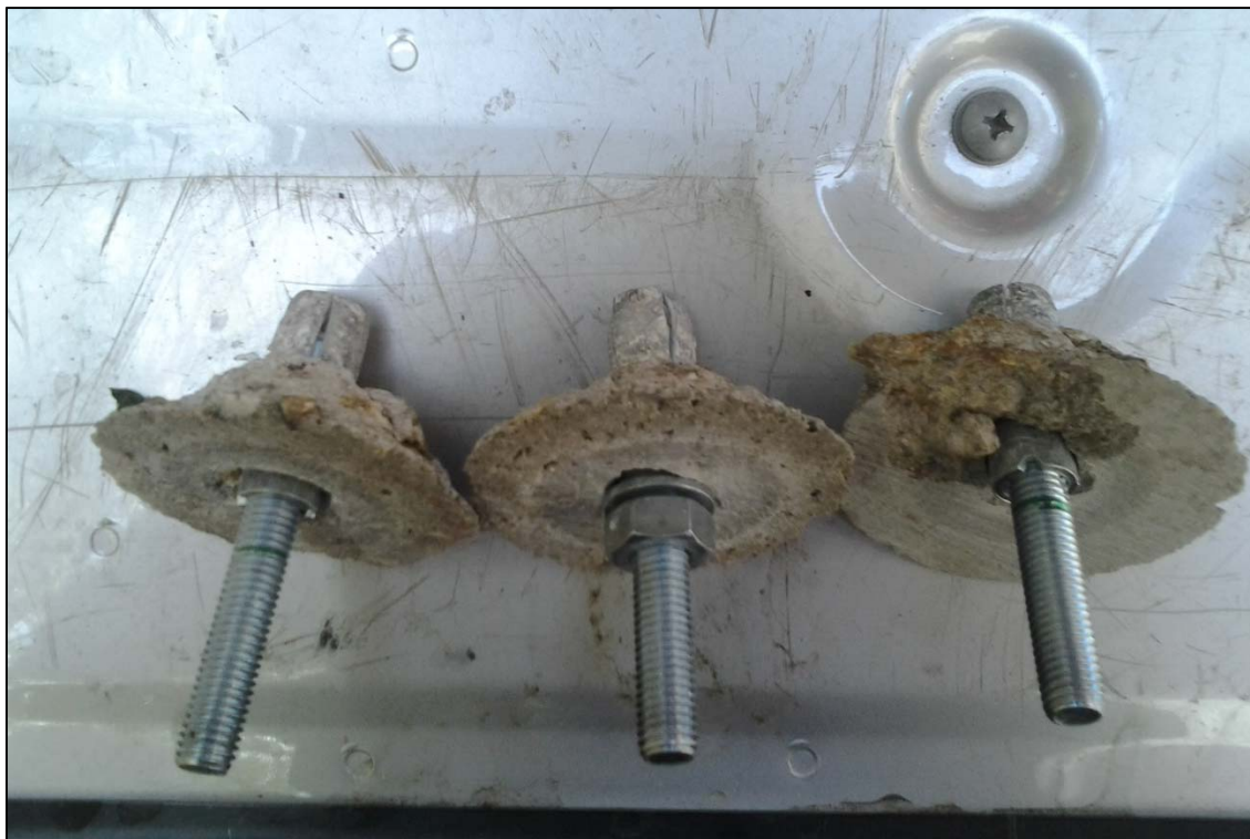
Figura 49 - Prove Pull Out. Tasselli Estratti
