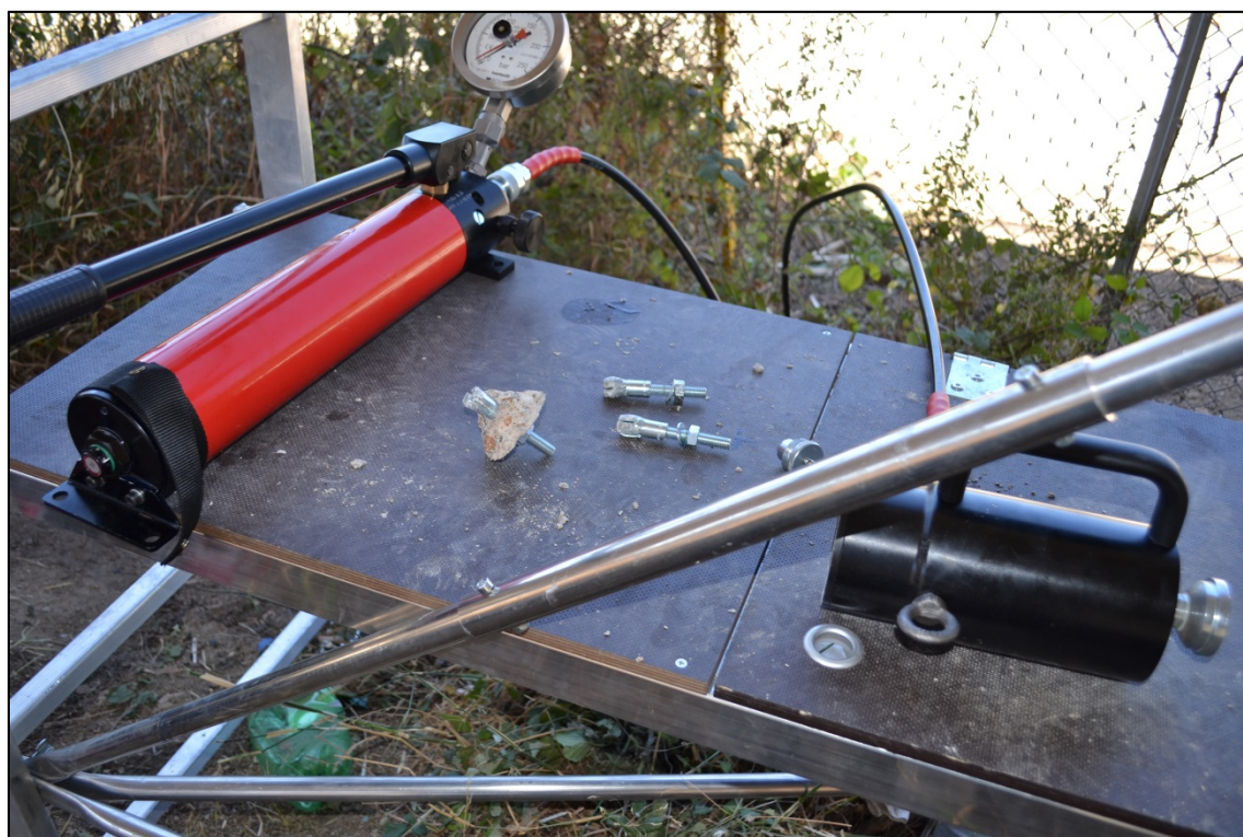
Figura 46 - Strumentazione per Prove Pull Out
