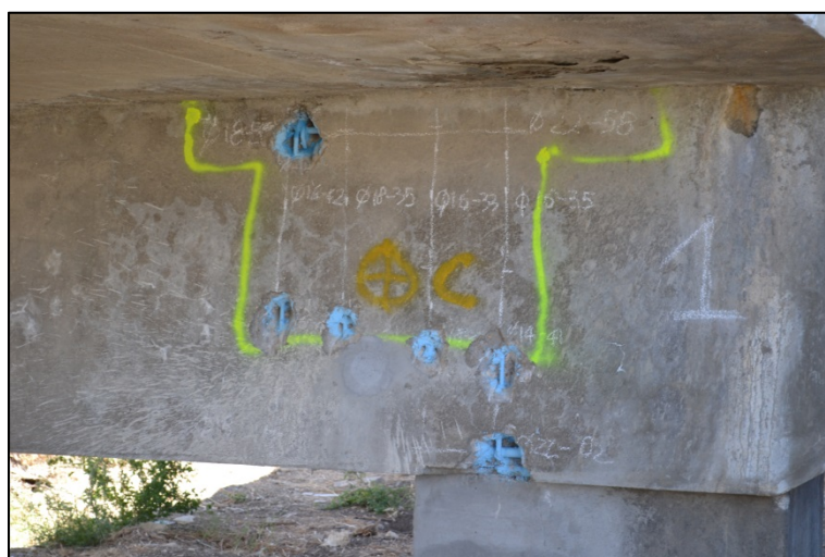
Figura 3 - Verifica dei Risultati dell'Indagine Pacometrica mediante Saggi Diretti
