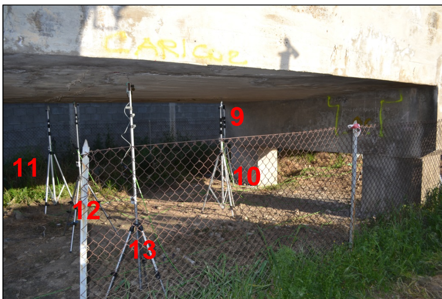
Figura 33 - Immagine del Posizionamento dei Trasduttori all'Intradosso di parte della Campata tra le Travi 12°-13° del Ponte Canale Guasila I, Prova del 15.04.2013
