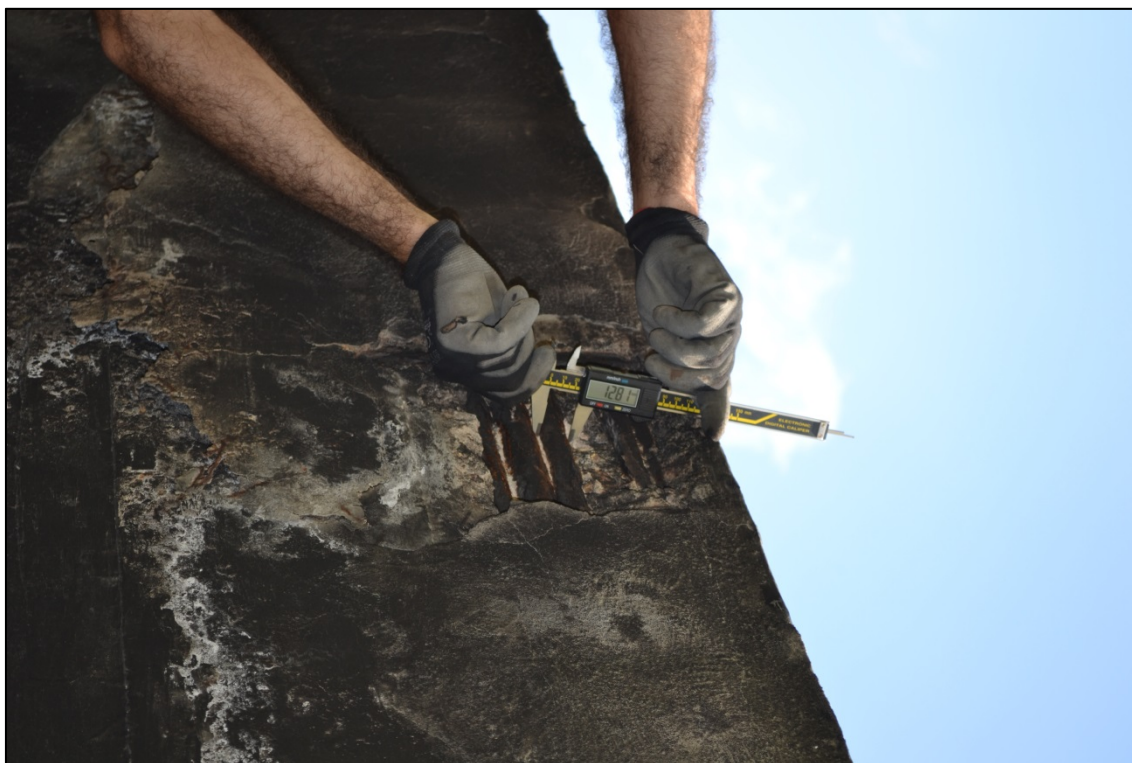
Figura 25 - Ponte Canale Guasila I - Campata Speculare - Misura del Diametro con Calibro Digitale
