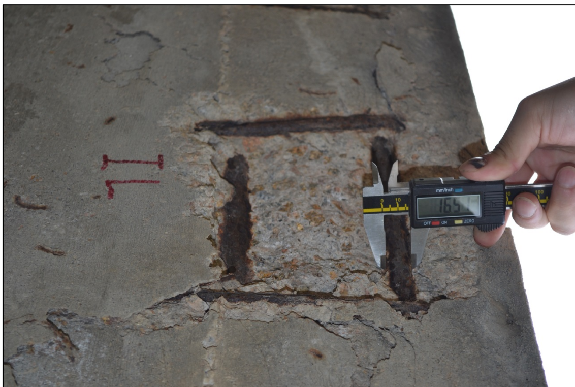
Figura 28 - Ponte Canale Guasila II - Misura del Diametro con Calibro Digitale
