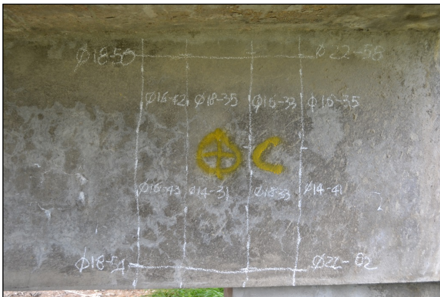
Figura 2 - Immagine di un Rilievo Pacometrico eseguito nella trave del ponte canale Guasila I
