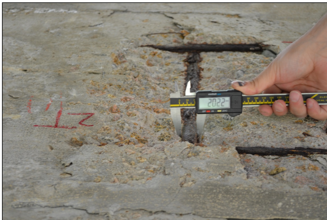
Figura 18 - Rilievo con Calibro su Armatura Trasversale Esterna all'Area Indagata con Georadar
