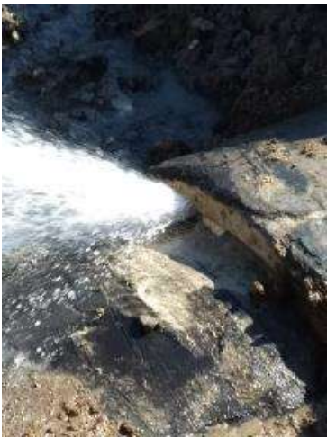
Perdita tipo su giunto tubo DN 1400
