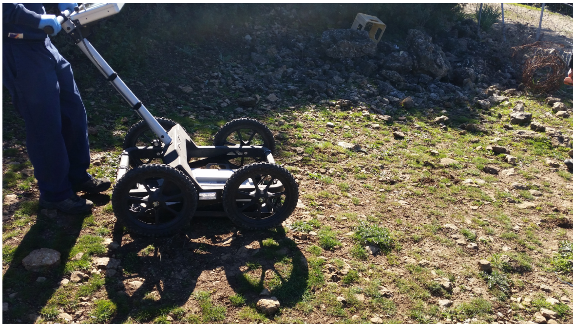
Figure 34: esecuzione delle misurazioni con il georadar
