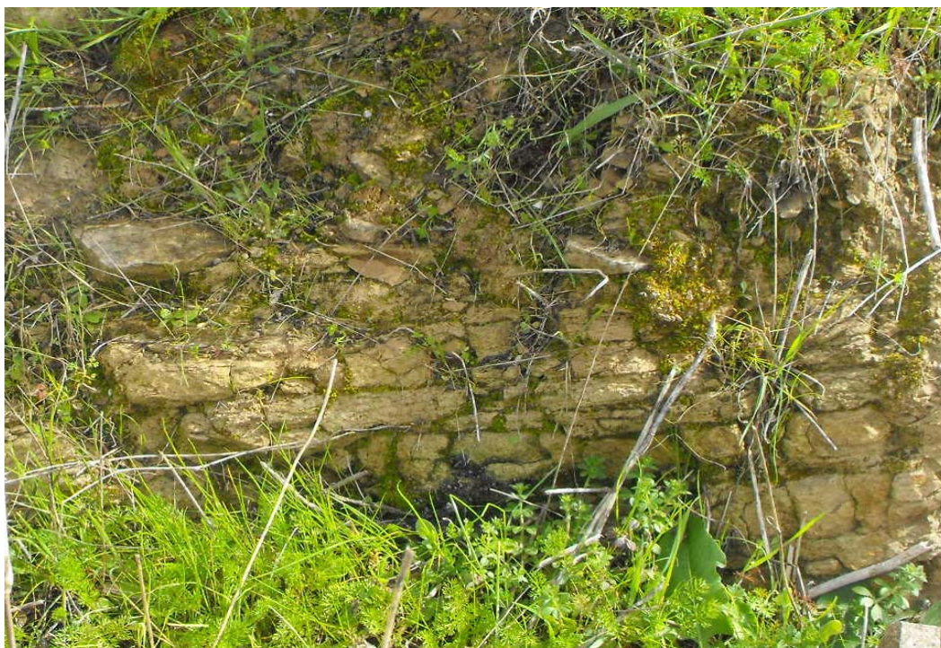
Figura 11. Marna fissile intensamente altera e disgregata in livelli sottili e friabili. In dx idraulica a monte del Ponte Canale I
