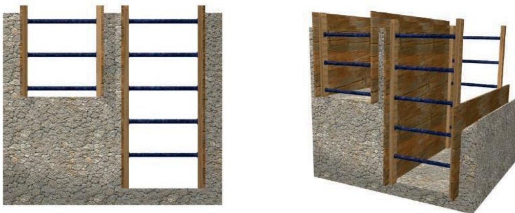
Figura 2 - Esempio di posizionamento di armatura in fasi parziali e successive di scavo
