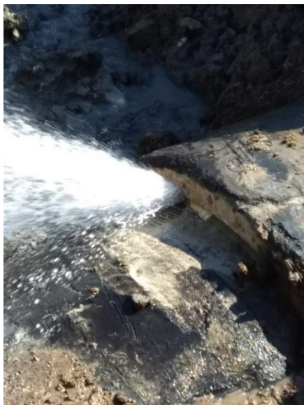
Perdita tipo su giunto tubo dn 1400
