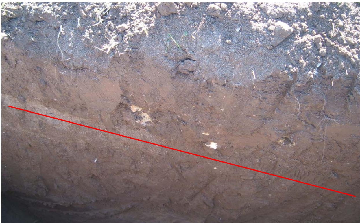
Figura 19. Particolare della sezione di scavo del pozzetto P1: si osservano i primi decimetri sciolti e rimaneggiati dall'attività agricola e, in parte, riportati a creare un argine in destra idraulica.
