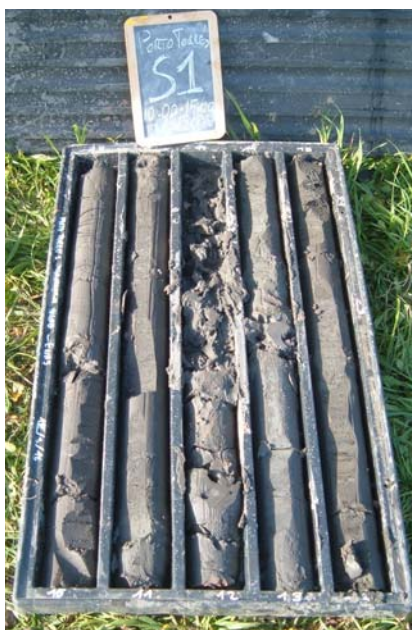
Figura 20. S1: limi sabbioso-argillosi rinvenuti oltre i 10 metri di profondità
